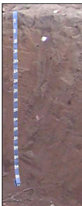
รูปที่ 3-8 หน้าตัดดินในพื้นที่หมู่บ้าน
